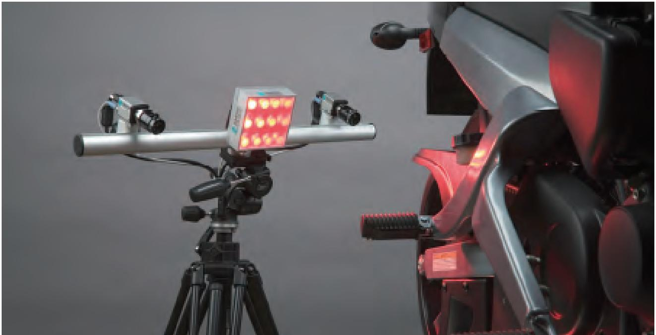
Q-400对任意材料和形状的非接触式全场三维变形测量
